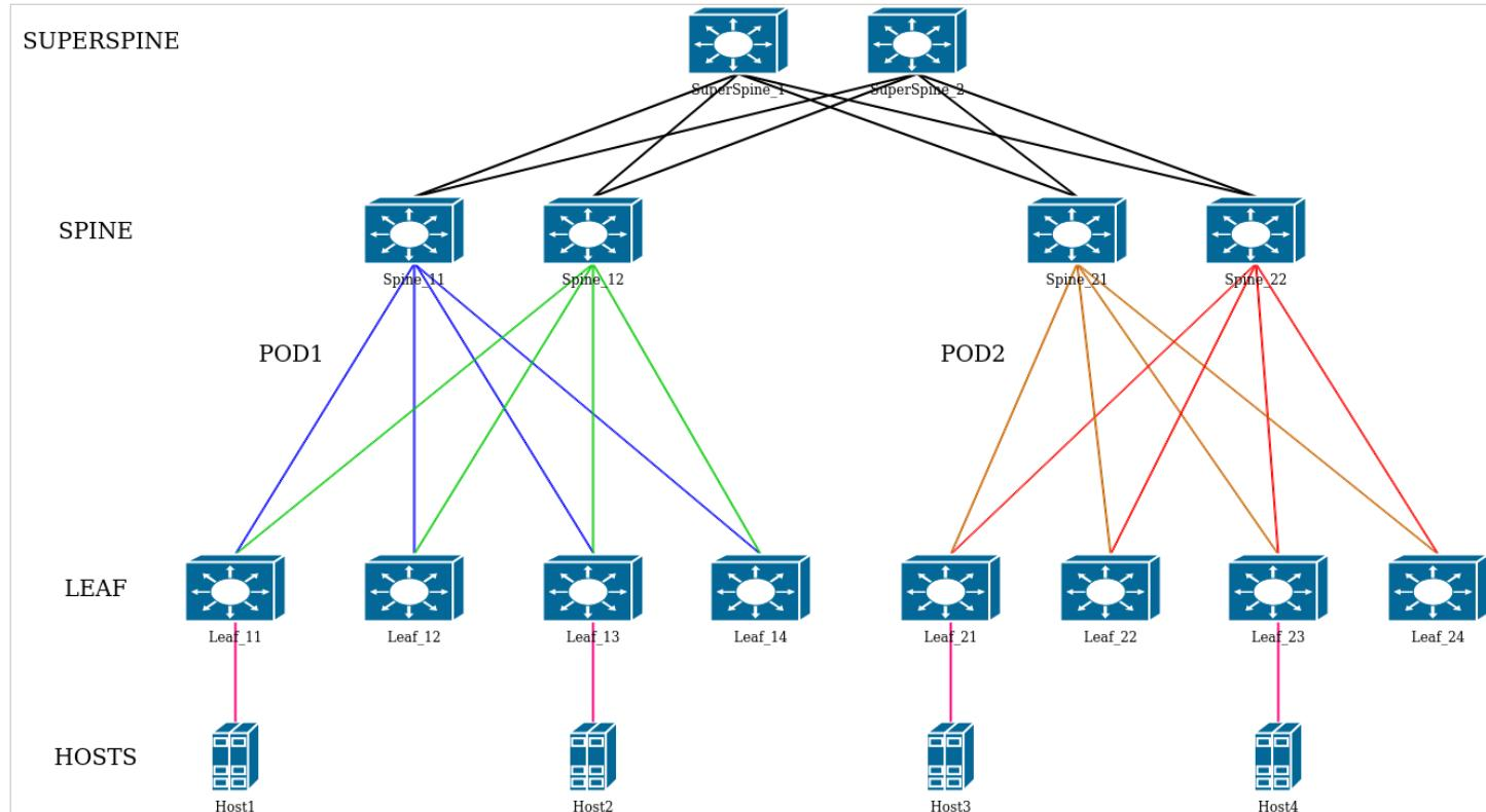
Появилось разделение на POD (см. [Используемые термины и сокращения](#)) и дополнительный уровень коммутации – SuperSpine или Spine второго уровня. Данная IP-фабрика состоит из двух POD. На схеме видно, что POD обособлены друг от друга – у Spine первого уровня (на схеме это устройства Spine\_11-22) есть соединения только с определенной группой Leaf – Leaf своего POD. Связь между POD осуществляется через Spine второго уровня.
