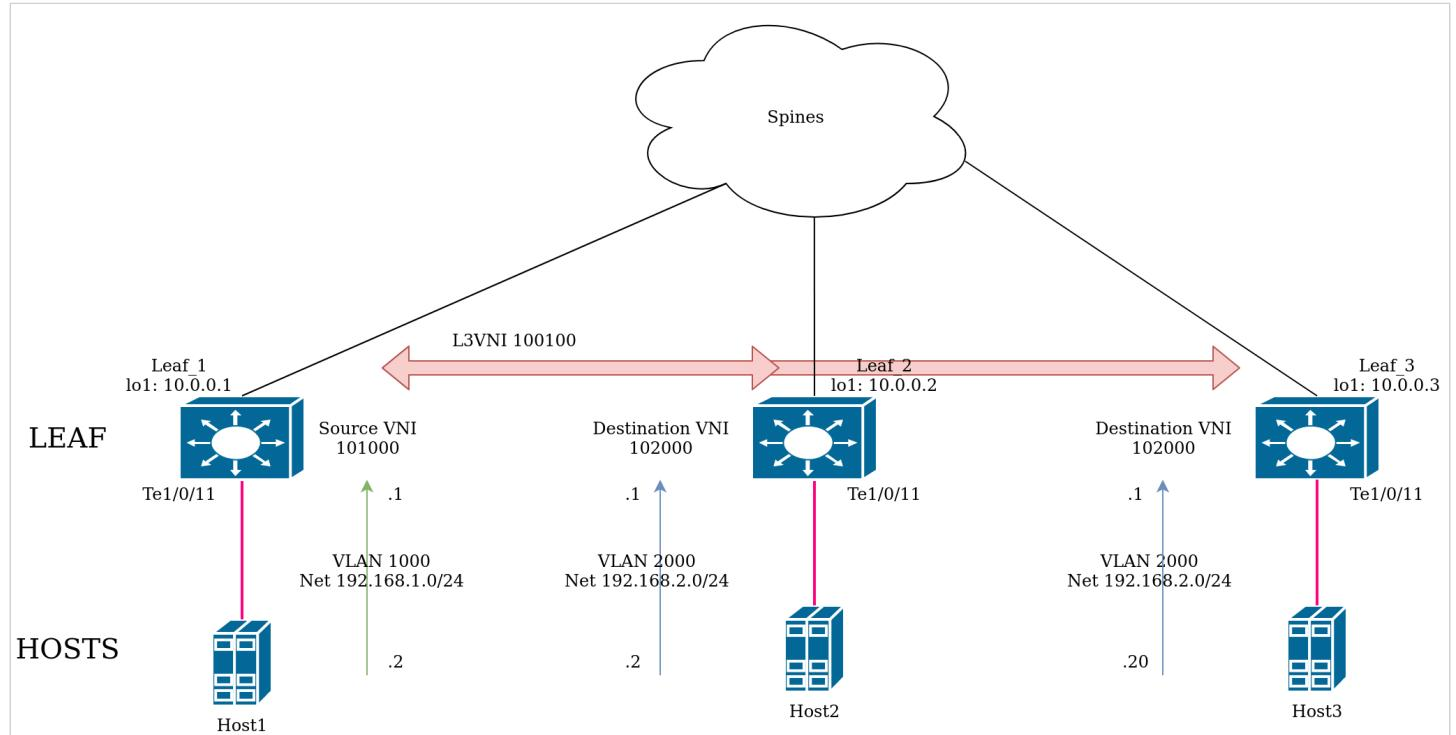
Anycast-gateway дополняет возможность различным Leaf выступать в роли шлюза для одной и той же сети. Хостам при переключении с одного Leaf на другой (например при миграции виртуальных машин) при использовании anycast-gateway нет необходимости обновления ARP-записи, т.к. MAC-адрес шлюза благодаря настройке не меняется от Leaf к Leaf. Подходит как для схем с multihomed-подключением, так и для случаев, когда одна и та же сеть разбита на несколько физических сегментов, подключенных к разным Leaf.
