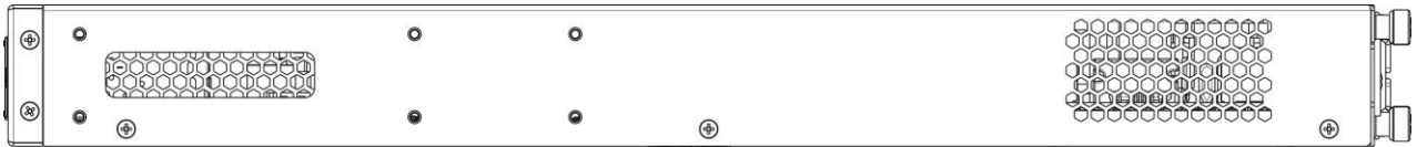
Рисунок 8 – Левая боковая панель маршрутизаторов ESR-1500, ESR-1510
