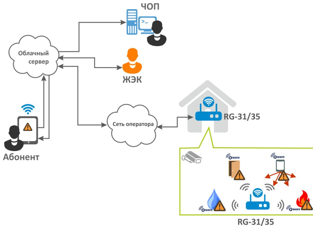
Схема реализована на оборудовании **ELTEX** с использованием **контроллера Z-Wave**, различных **датчиков** (объемники, концевики, датчики размыкания, датчики температуры, затопления, газовые и др.) и камеры видеонаблюдения.
