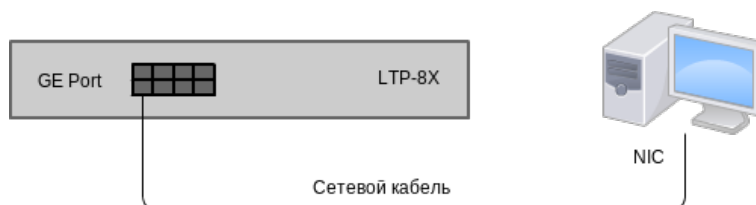
Рисунок 14 – Подключение терминала к PC сетевым кабелем
