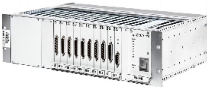
Гибкий мультиплексор Маком-MX предназначен для формирования первичных цифровых потоков со скоростью 2048 кбит/с (поток E1) и передачи по ним аналоговых речевых сигналов и сигналов цифровых интерфейсов, электронной кроссовой коммутации цифровых каналов со скоростью 64 кбит/с, передачи цифровых потоков по сети IP/Ethernet, по SHDSL-линиям, для конвертации физических стыков и линейной сигнализации.
