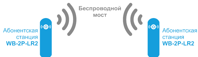
Функциональная схема использования WB-2P-LR2 для организации беспроводного моста
