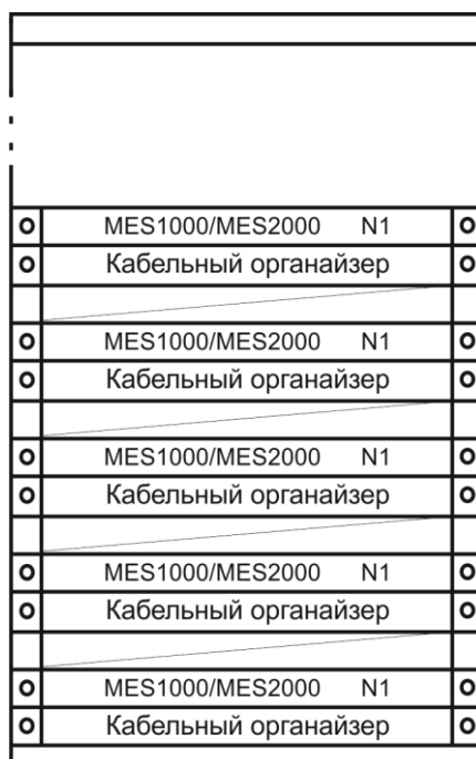
Рисунок 23 – Размещение коммутаторов в стойке
