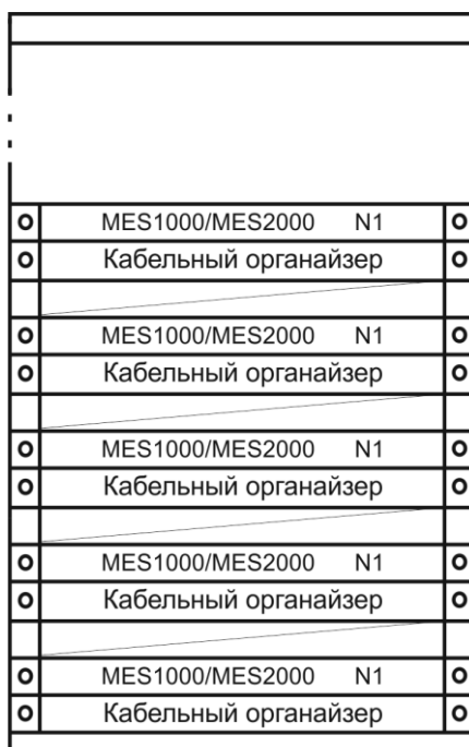
Рисунок 23 – Размещение коммутаторов в стойке
