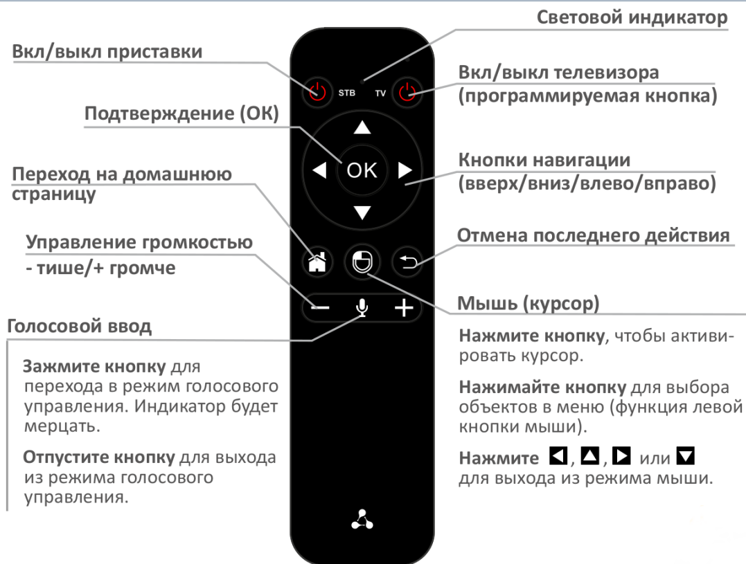
Рисунок 7 – Универсальный Bluetooth-пульт дистанционного управления Смарт ТВ-приставкой и телевизором
