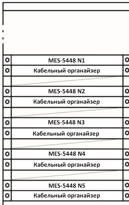
Рисунок 13 – Размещение коммутаторов MES5448 в стойке
