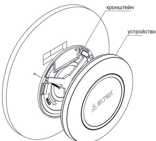
Рисунок 8 – Установка устройства (вид спереди)
