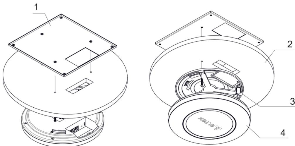
1 – металлический кронштейн; 2 – панель армстронг; 3 – пластиковый кронштейн; 4 – устройство.
