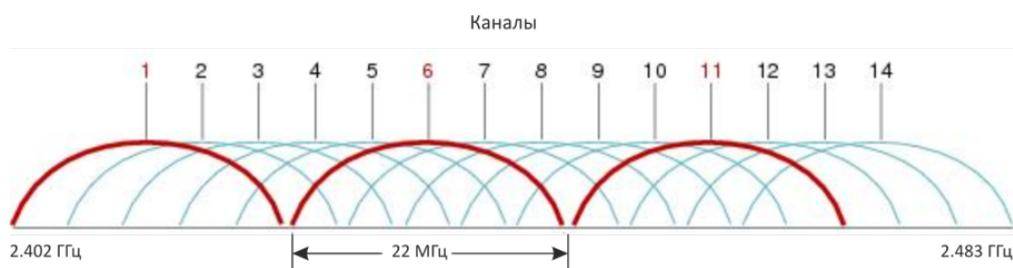
Рисунок 3 – Общая диаграмма перекрытия частотных каналов в 2,4 ГГц
