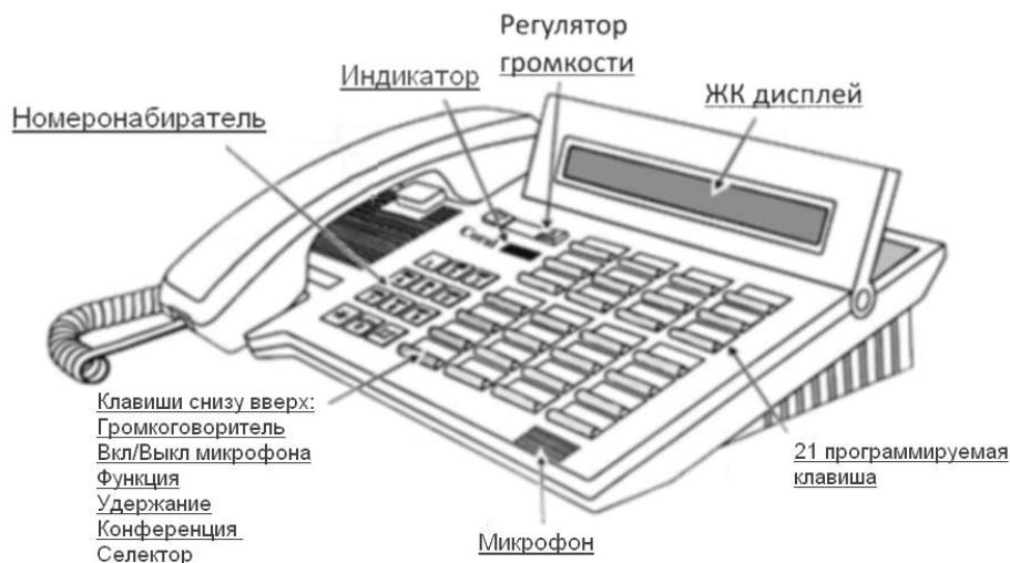
Рисунок 3 – Расположение элементов управления системного телефонного аппарата серии DKT-R2321
