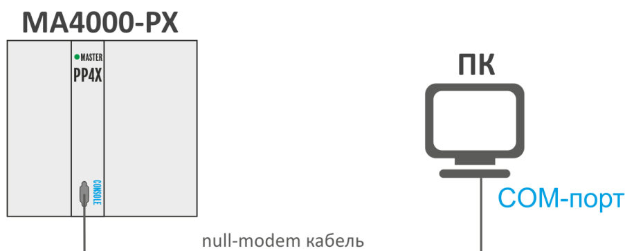
Рисунок 16 – Подключение узла доступа к компьютеру через СОМ-порт
