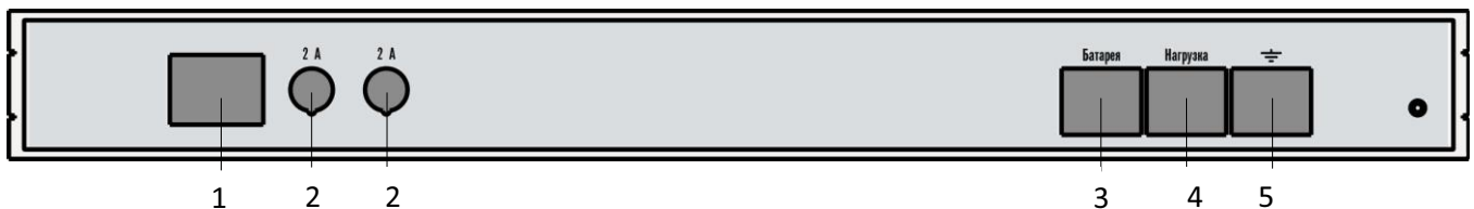
Рисунок 2 – Разъемы на задней панели УЭП 1-1
