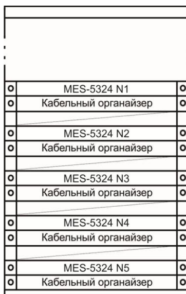
Рисунок 34 – Размещение коммутаторов MES5324 в стойке
