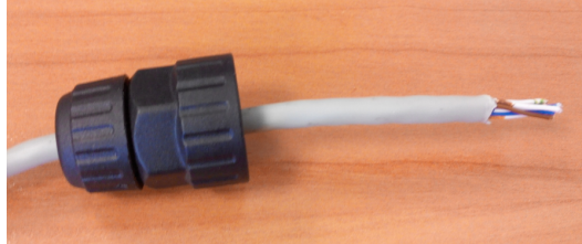
Рисунок 14 – Крепление ответной части на кабеле
