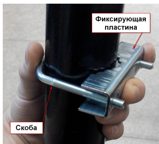
Рисунок 9 – Установка скобы и фиксирующей пластины
