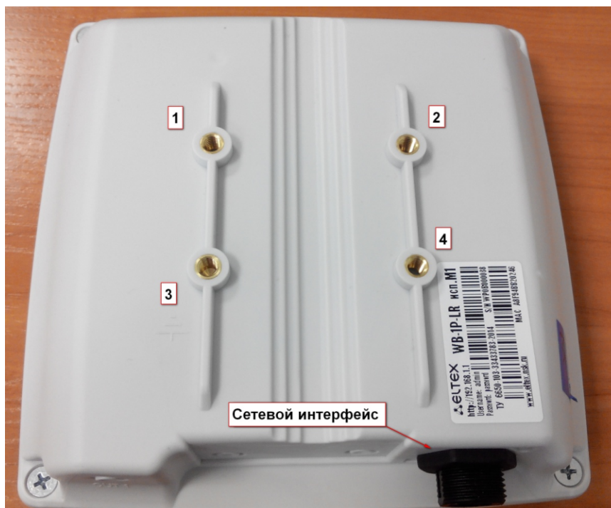
Рисунок 5 - Элементы крепления на устройстве
