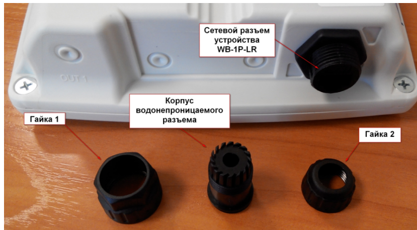
Рисунок 12 – Герметичный разъем RJ-45 на устройстве и ответная часть в разобранном виде
