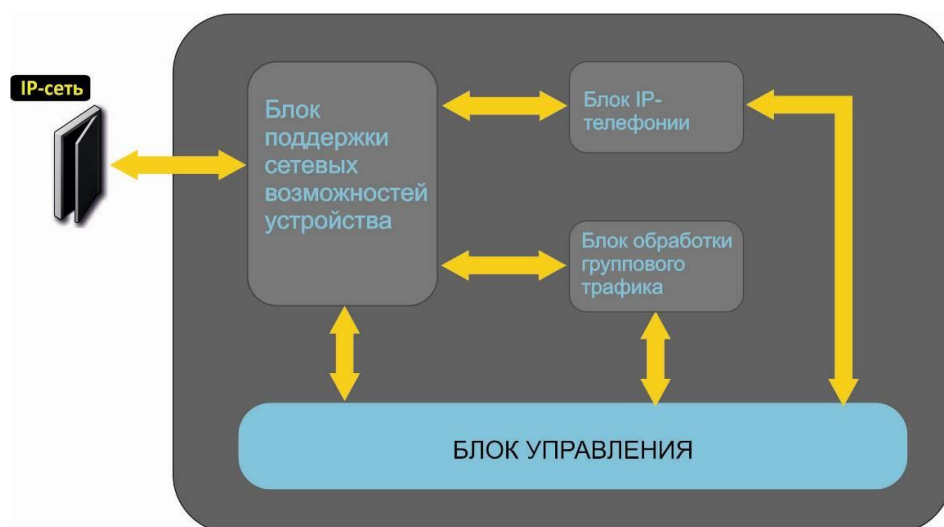
Рисунок 3 – Функциональная схема TAU-8.IP
