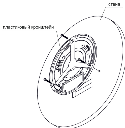
Рисунок 7 – Крепление кронштейна на стене
